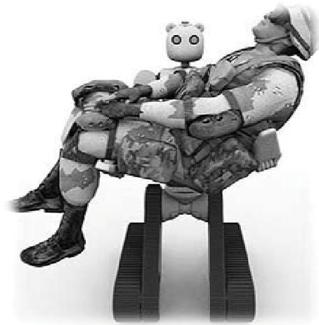
**Figura 6.** Robot de rescate de soldados BEAR (*Battlefield Extraction-Assist Robot*).
